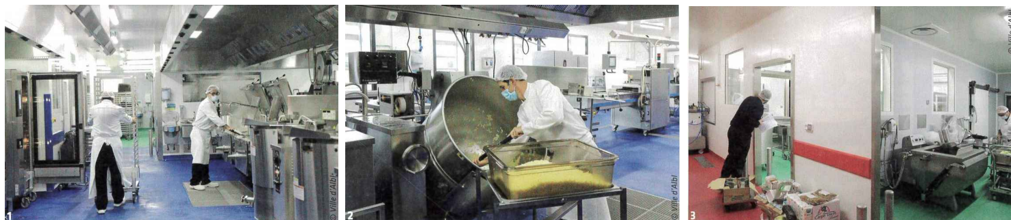
1 EFC a connecté la plupart des équipements via le plafond grâce à un plénum technique raccordé à des portiques en inox réalisés sur mesure. 2 Dans les marmites, les cuissons créoles sont refroidies par l'ajout en fin de cuisson de plusieurs dizaines de kg de glace. 3 Un revêtement de sol en résine avec trois couleurs différentes (rouge, vert et bleu) identifie les différentes zones. 4 Les plans de travail avec bac de lavage sont mobiles et peuvent se positionner en fonction des besoins des opérateurs sous des robinetteries murales. Ici la légumerie.
